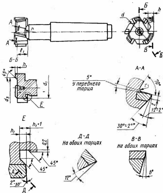
\* Задняя поверхность зубьев фрез может быть выполнена двугловой или криволинейной формы.
