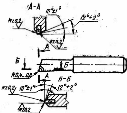
3. Геометрические параметры цилиндрических вставок
