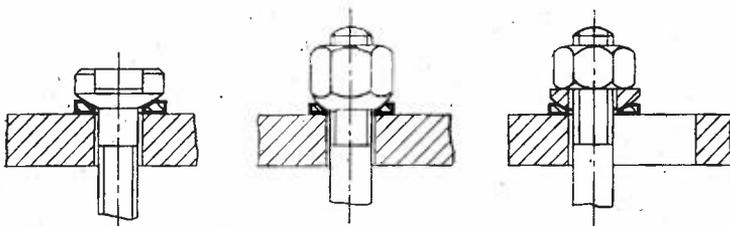
Изменение № 2 ГОСТ 13439—68 Шайбы конические для станочных приспособлений. Конструкция и размеры
