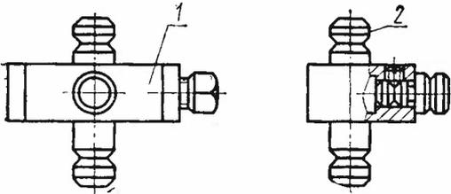
1 — плоская опора; 2 — установочный цилиндрический палец по
