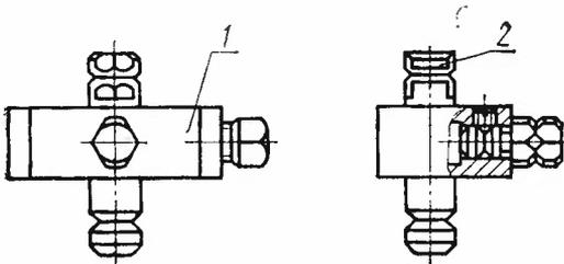
1 — плоская опора; 2 — установочный цилиндрический срезанный
