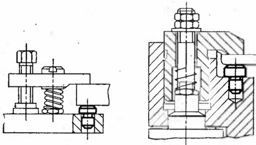
Изменение № 2 ГОСТ 13440—68 Опоры постоянные с плоской головкой для станочных приспособлений. Конструкция и размеры
