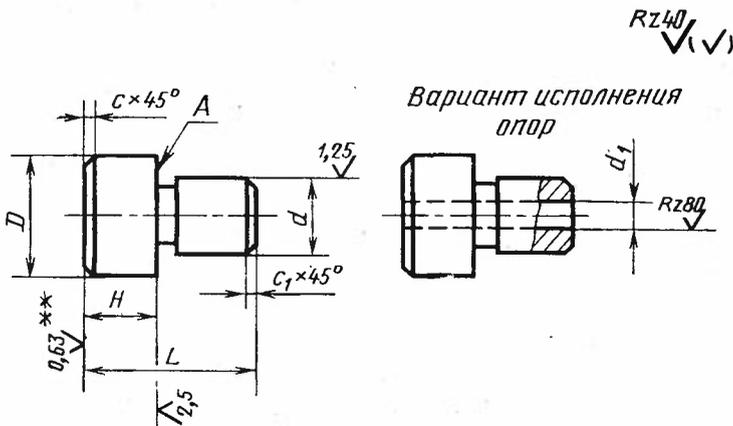
\*\* Для опор, изготовляемых с припуском на шлифовку, шероховатость плоскости — Rz40 мкм.
