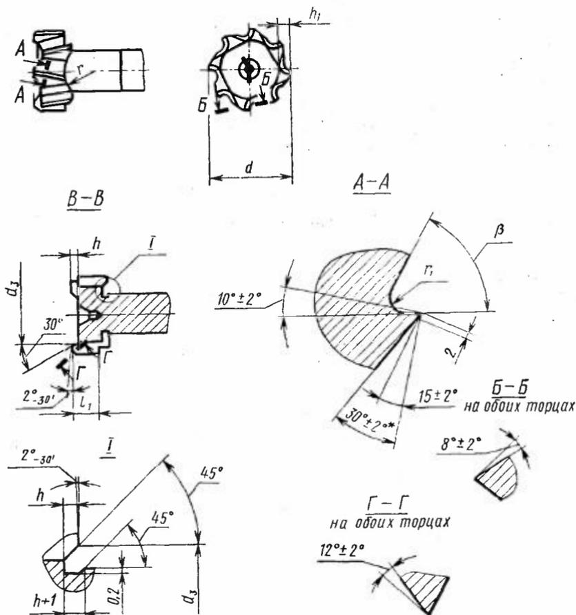
\* Задняя поверхность зубьев фрезы может быть выполнена двухугловой или криволинейной формы.
