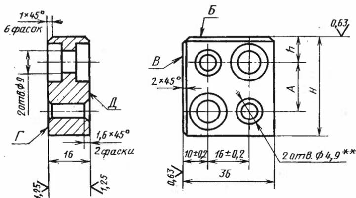
\*\* Отверстия под штифты развернуть при сборке с предельными отклонениями по К7.
