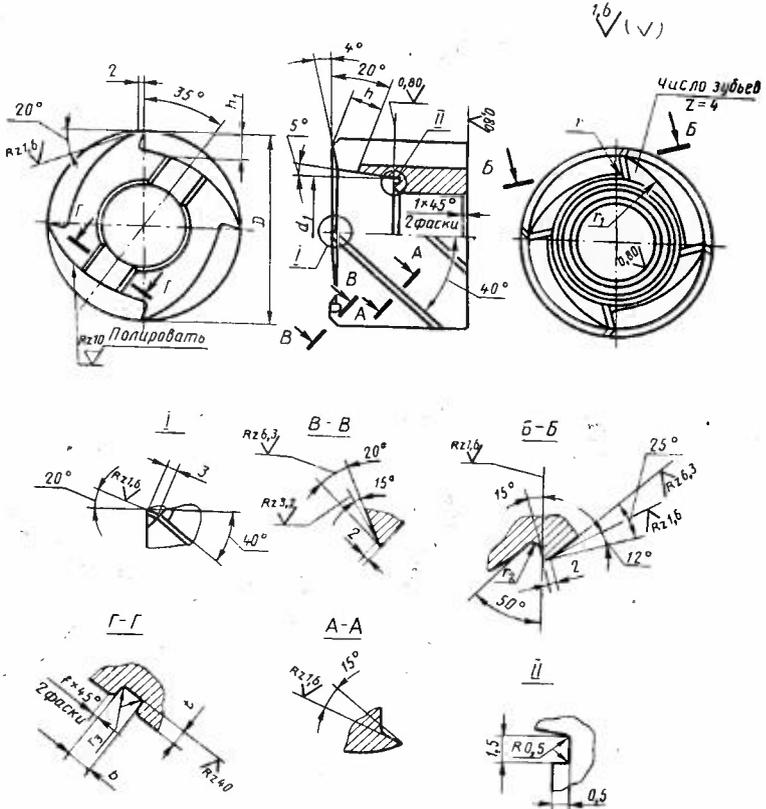
Примечание. Острые кромки на спинке торцового зуба скруглить.
