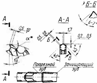
\*  $\alpha = 16^\circ$  для фрез с крупным зубом;  $\alpha = 20^\circ$  для фрез со средним зубом.
