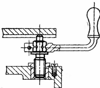
**Изменение № 2 ГОСТ 4740—68 Опоры регулируемые усиленные для станочных приспособлений. Конструкция и размеры**
