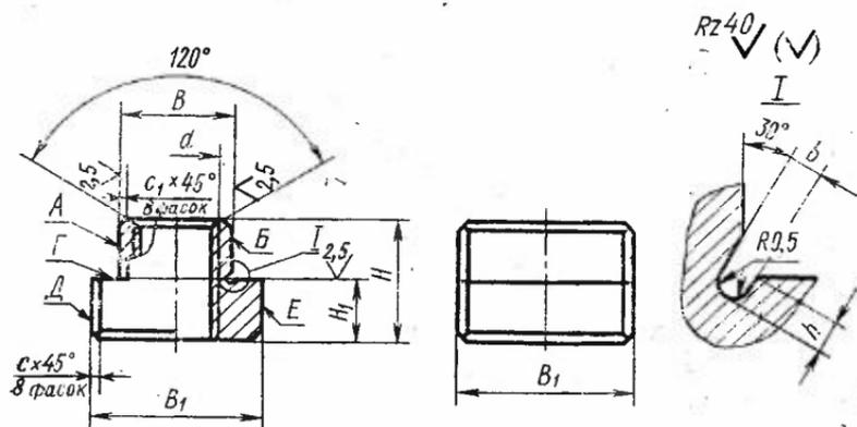
2. Материал — сталь марки 45 по ГОСТ 1050—74. Допускается замена материала на сталь других марок с механическими свойствами не ниже, чем у стали марки 45.
